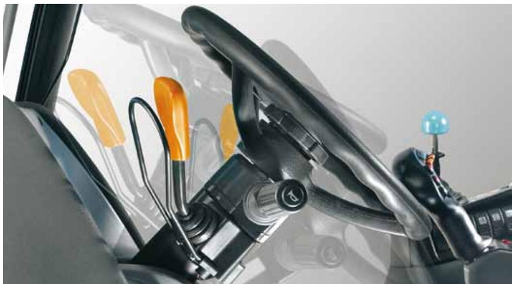
Con la leva PowerShuttle è possibile invertire rapidamente e comodamente il senso di marcia, senza dover premere il pedale della frizione. Non c'è nulla di più semplice.
