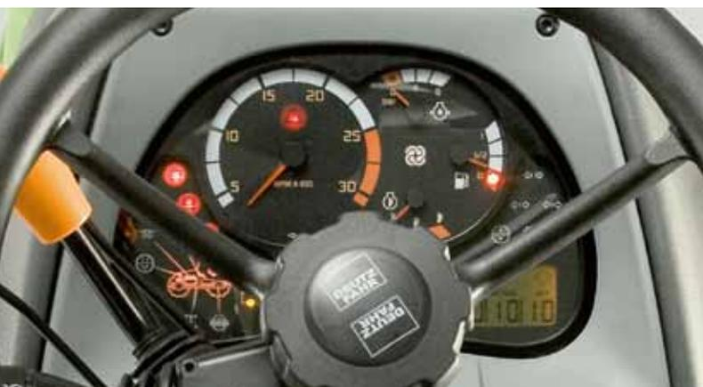
Il display Info centrale comprende tutte le principali segnalazioni relative a motore, trasmissione, computer di bordo e funzioni automatiche.
