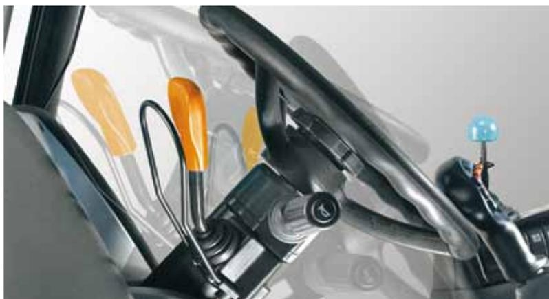
Sotto il volante in posizione comoda si trova la leva shuttle per l'inversione di marcia senza premere la frizione.
